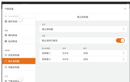
您最多可以使用4个独立加热器，可在控制器设置分配至相应区域。
