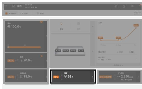
**操作。**通过温度卡片可以查看并调整最重要的温度数值。卡片的正面显示当前的室内温度以及所需的空气湿度。以下章节内容介绍了可用于湿度的功能和设置选项。
