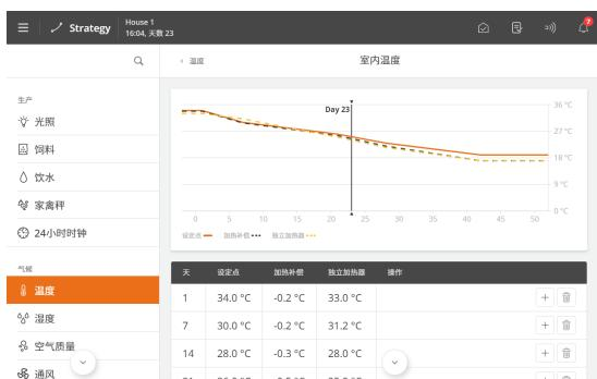
控制器将根据制定的策略不断调整气候以适应动物的年龄和需求。
